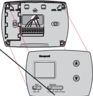
Gire el termostato e inserte baterías AA alcalinas nuevas; luego, vuelva a instalar el termostato.
