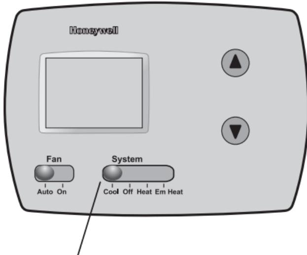
El interruptor “SYSTEM” puede configurarse para controlar su sistema de calefacción o refrigeración.
