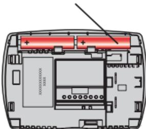
Las baterías son opcionales (para ofrecer energía de respaldo) si su termostato fue conectado para funcionar con corriente CA cuando fue instalado.
